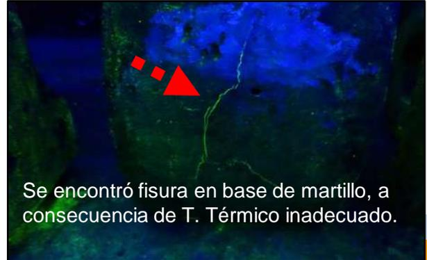
Se encontró fisura en base de martillo, a consecuencia de T. Térmico inadecuado.
